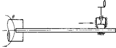
图 36.2-1 扭板弹簧加载器原理简图
